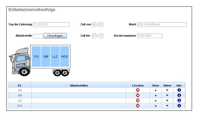
Durch Klicken der Pfeile ▲ ▼ in der Spalte Oben bzw. Unten kann die Reihenfolge der Entladezonen verändert werden.
